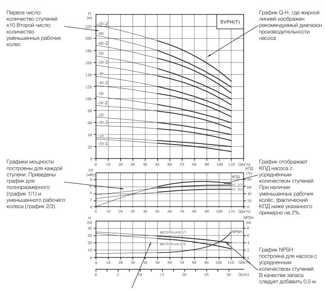
Приведены графики Q-H для каждого рабочего колеса: для полноразмерного (график 1/1) и для уменьшенного рабочего колеса (график 2/3)
