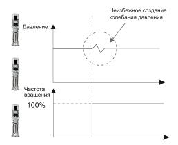
При включении или останове насоса отсутствует жесткий контроль частоты вращения. Это приводит к созданию колебания давления в напорной линии.
